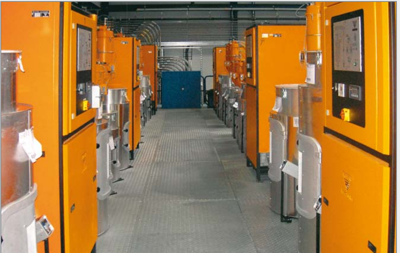
Trocknungsanlage aus CKT-Trocknern eines Kunststoffverarbeiters. Hier werden Hochleistungskunststoffe wie PPS, PEEK, PEI, PPA getrocknet.
